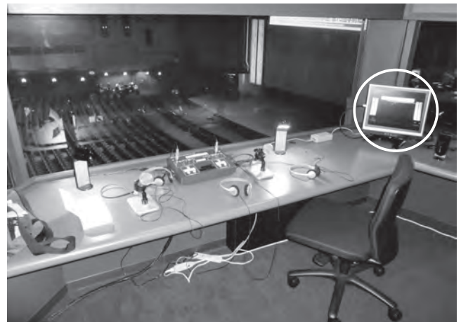
図4 スクリーンが斜めに見えるブースでは液晶モニタを設置 白色の囲みが液晶モニタである。これによって斜めからでは見にくいスクリーンの情報を完全にみることができる。
